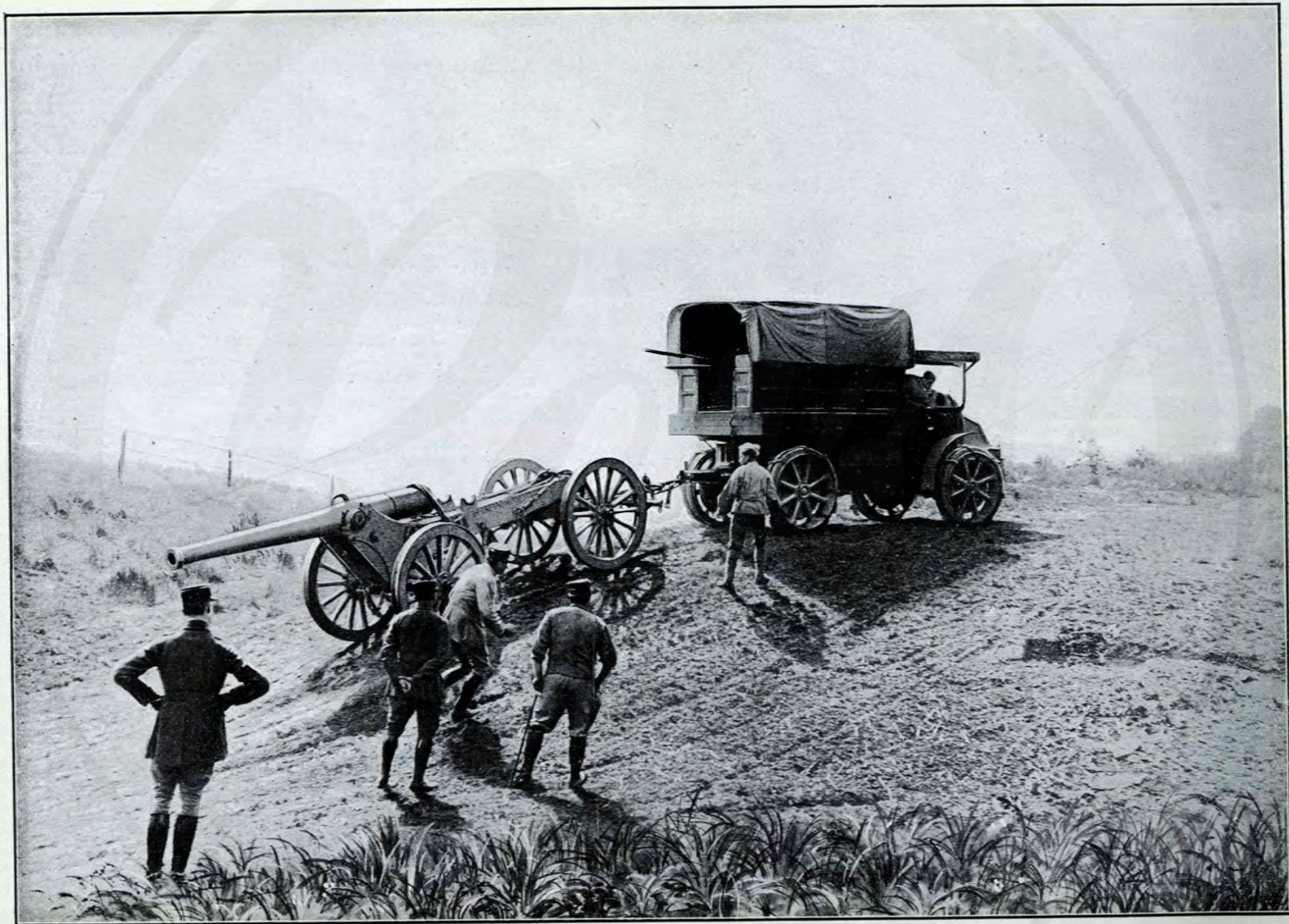
Manœuvre du 120 long à l'aide d'un tracteur Latil, muni de Bandages Bergougnan.
