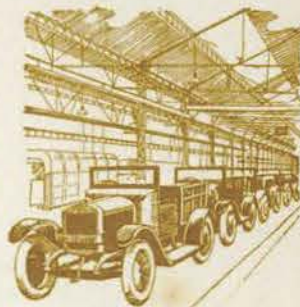
Le montage en ligne.
