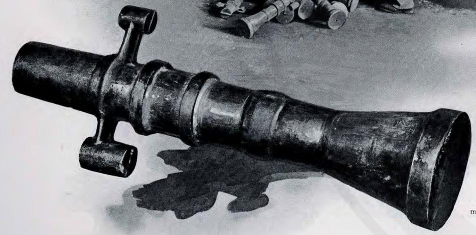
Forgeage d'un manchon de pont AR à cardan.
